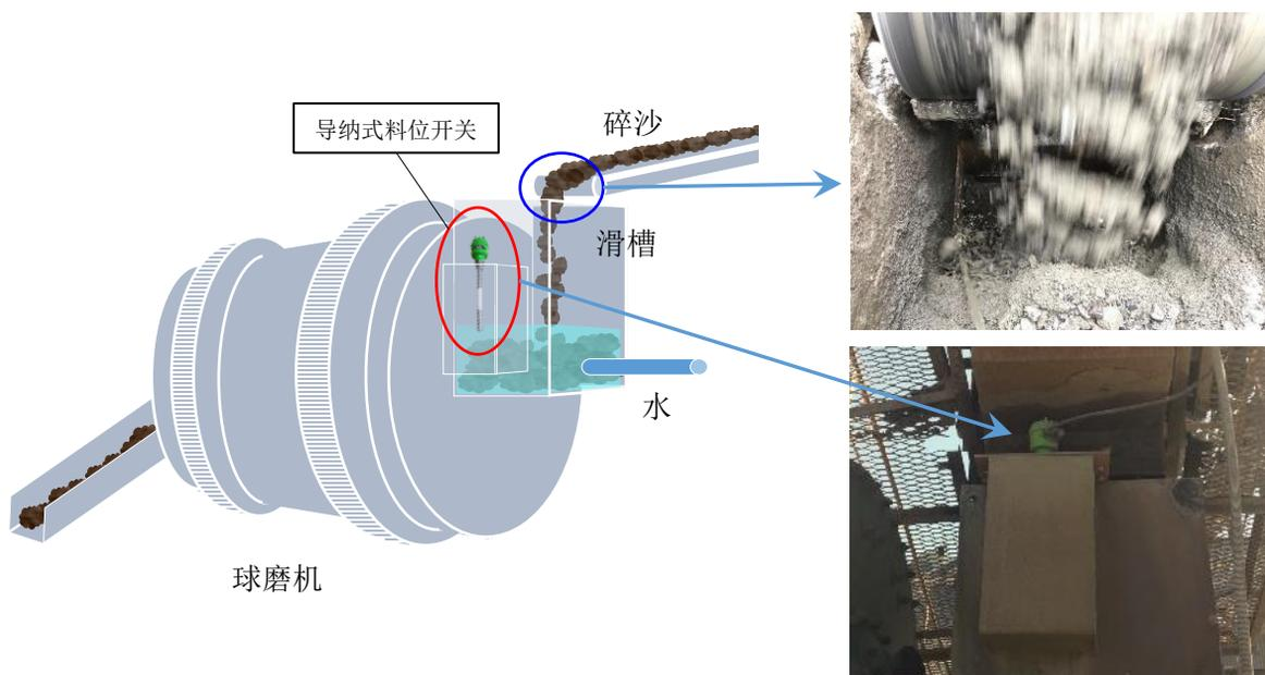
※照片（上）：投入使用BC搬送的碎石滑槽的当下。
